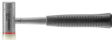
FERROPLEX ist der 2 in 1 Kombihammer von Halder für alle diejenigen, die weder auf die Vorteile eines Stahlhammers noch auf die Vorzüge eines Schonhammers verzichten wollen. Der Hammerkopf ist aus hochwertigem Vergütungsstahl und an der Schlagfläche sorgfältig induktiv gehärtet.
