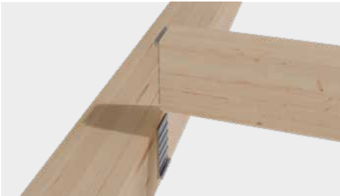
Schritt 3: Haken Sie den Nebenkanten von oben nach unten ein. Stellen Sie sicher, dass beide Connecto-Teile parallel zueinander ausgerichtet sind, um übermäßige Spannungen bei der Montage zu vermeiden.
