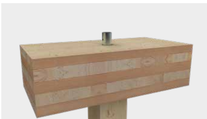
Schritt 5: Aufsetzen des Deckenelements.
