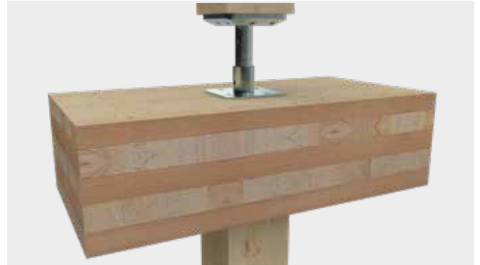
Schritt 8: Einsetzen des Oberteils in den Unterteil.
