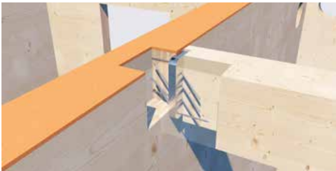
Magnus Einhängeverbinder zur Montage eines Balkens an einer Wand.
